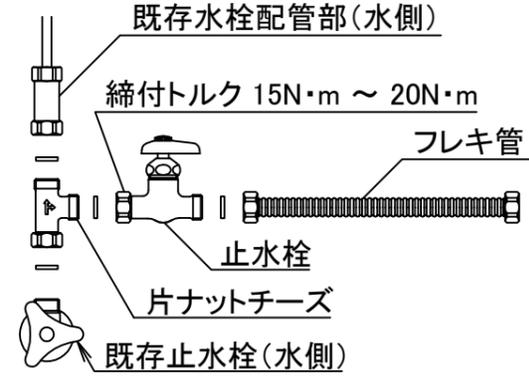
4. フレキホース先端は専用水栓の給水側(シール)と確実に接続してください。
