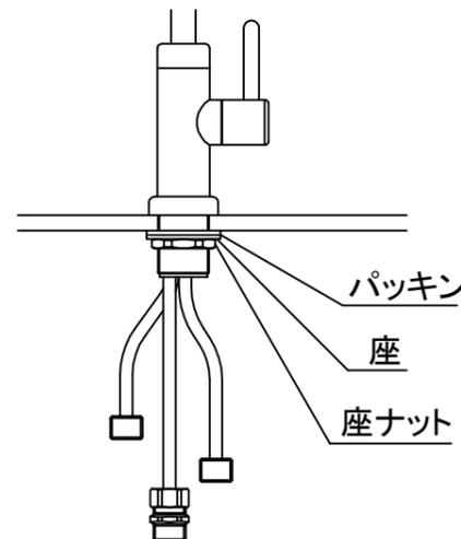
座ナットの締付け工具は対辺寸法38をご使用ください。
