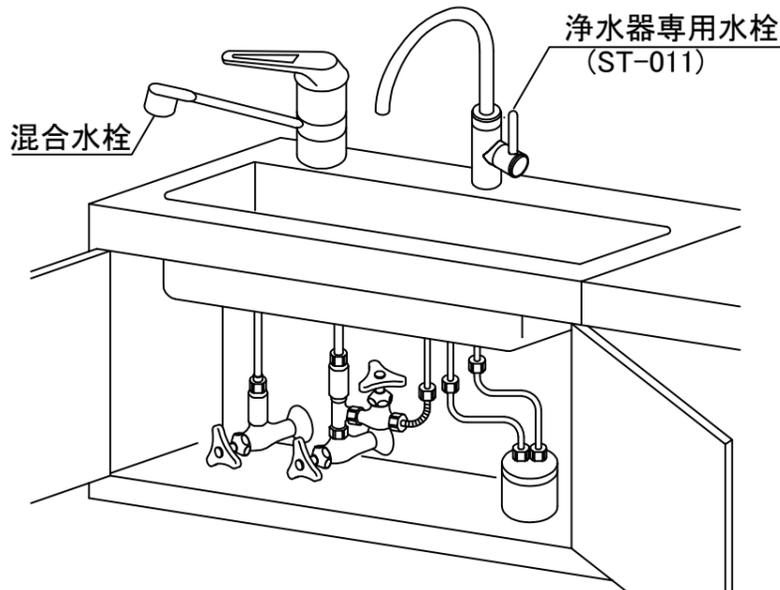
専用水栓の取付穴は、水栓の取付可能な位置に直径34~36mmの穴を開けてください。
